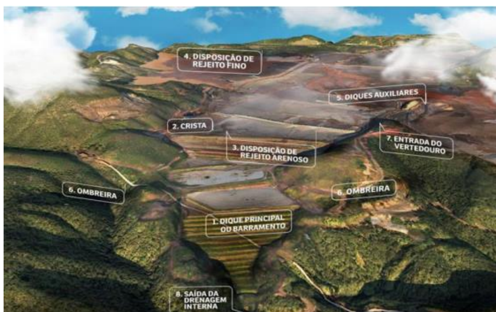
Figura 1 – O que é uma barragem. (Disponível em: < https://www.samarco.com/wp-content/uploads/2016/08/o-que-e-uma-barragem.pdf >. Acesso em: 18 ago. 2020.)
