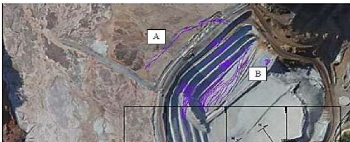
Figura 11 - Imagem com representação das trincas de tração (A) e compressão (B) na região do eixo recuado junto à OE. (Disponível em: < http://www.mpf.mp.br/mg/sala-de-imprensa/docs/denuncia-samarco >. Acesso em: 18 ago 2020.)
