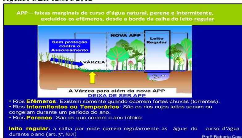
Figura 02 11 – Esquema gráfico do referencial da borda da calha do leito regular, segundo a Lei 12.651/2012
